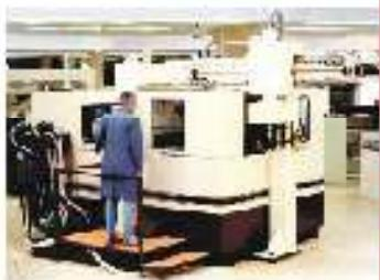
**5 polohové CNC obráběcí centrum** pro dopravní komponenty ve Velké Britanii. Vodící plochy jsou opatřeny povlakem **MOGLICE**, který je proveden v jedné operaci bez dalších víceprací.
