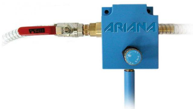
Směšovací jednotka je nezbytná pro míšení chladicích emulzí. Prostřednictvím jehlového ventilu umožňuje ARIANA směšovač rychlé a přesné nastavení koncentrace emulze kapalných chladiv a maziv. Tímto způsobem dosáhnete optimální koncentrace.
